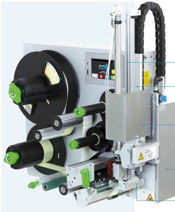
Die HERMES Q sind für das automatische Drucken und Etikettieren in Fertigungslinien konzipiert. Verschiedene Applikatoren bringen das Etikett durch Anrollen, Anblasen oder Andrücken auf Produkte oder Verpackungen.
