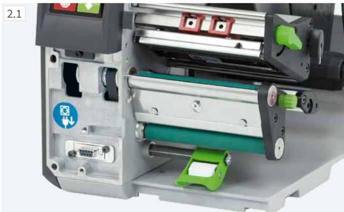
**Alle Druckköpfe sind bei gleicher Breite beliebig austauschbar. Sie werden von der CPU automatisch erkannt und kalibriert.** Wichtige Daten wie Laufleistung, maximale Betriebstemperatur und Heizenergie werden direkt im Druckkopf gespeichert. Die Werte können im Werk ausgelesen werden.
